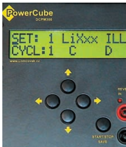
▲ Frontansicht: Startmenü mit großem Display, Cursor und Bedienelementen
