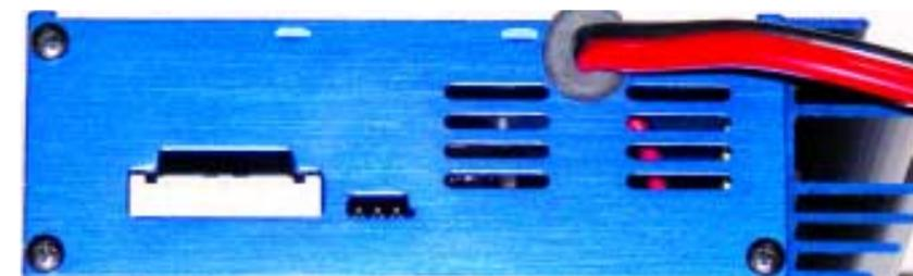
Rechts befinden sich die Balanceranschlüsse und die USB-Schnittstelle zum PC
