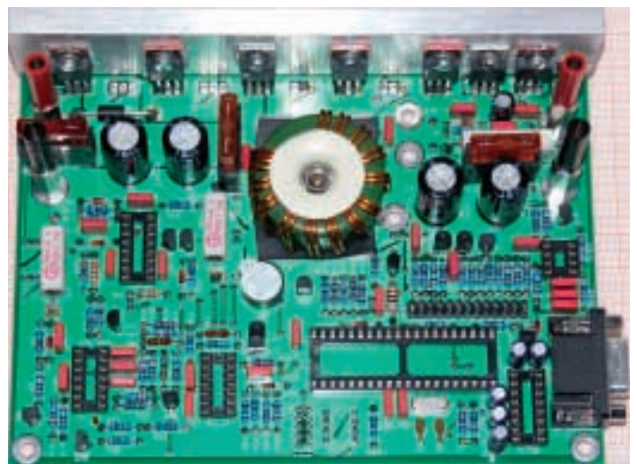
Fertig zu den ersten Teil-Funktionsüberprüfungen. Gut sichtbar die Kfz-Sicherungen
