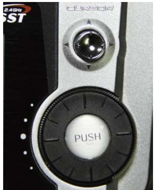
Das zentrale Bedienkommando mit dem Joystick (oben) und dem 3D-Bedienrad
