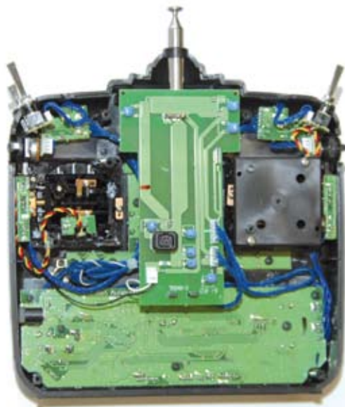
Aufgeräumte Technik und stark verdrillte Leitungen: Die Antenne ist schraubbar und bei 2,4-Gigahertz-Nutzung nicht vonnöten
