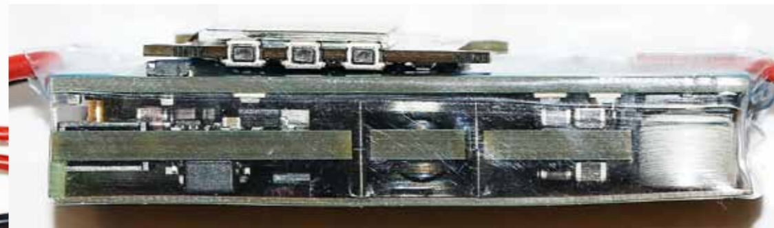
Seitenansicht des HV2BEC mit aufgesetztem OLED. Seitlich sind drei Bedientaster am OLED angebracht
