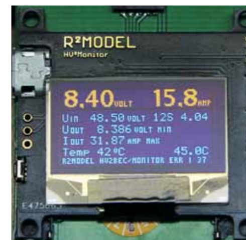
Das Display mit den Live-Daten: BEC-Spannung, BEC-Strom, Eingangs-/Ausgangsspannung und Temperatur (Minimum/Maximum-Werte)
