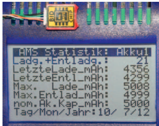
Hier ist der Lebenslauf eines Akkus, wie er im AMS- beziehungsweise BID-Chip speicherbar ist, komplett sichtbar
