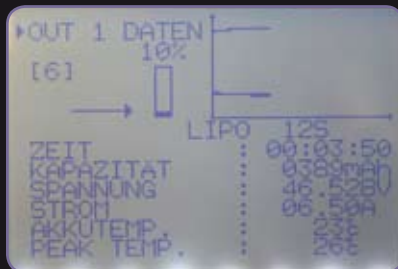
Ladepower: Hier sind das satte 303 Watt Ladeleistung an zwei 6s-LiPos und 12,2 Volt Eingangsspannung
