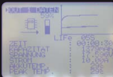
Teil 1 der Ladeanzeige mit grafischer Darstellung zum Füllstand, dem Spannungs- sowie Temperaturverlauf
