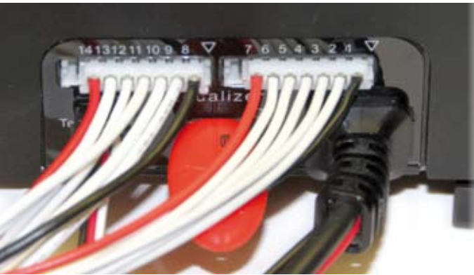
Ansicht der Balanceranzeige während der Vollast-Ladung von zwei 6s-LiPos
