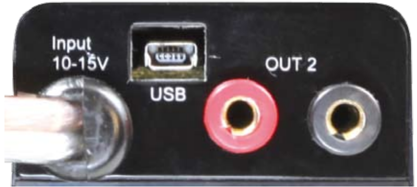
Linke Anschlussseite: USB-Anschluss und OUT 2-Buchsen
