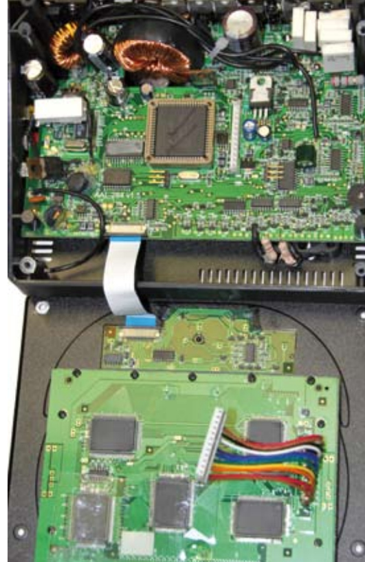
Oben ist die Hauptplatine, unten die Anzeigeplatine mit Display. Der Hauptprozessor steckt in einem Sockel
