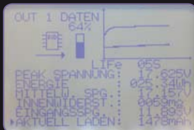
Teil 2 der Ladeanzeige mit Innenwiderstandswert
