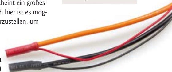
OUT 1-Anschluss mit zusätzlichen Leitungen (Vierleiteranschluss)
