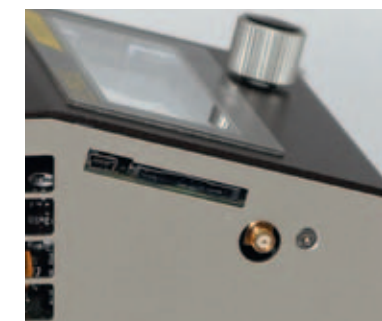
USB-Schnittstelle, SD-Kartenslot und optionaler Bluetooth-Antennenanschluss
