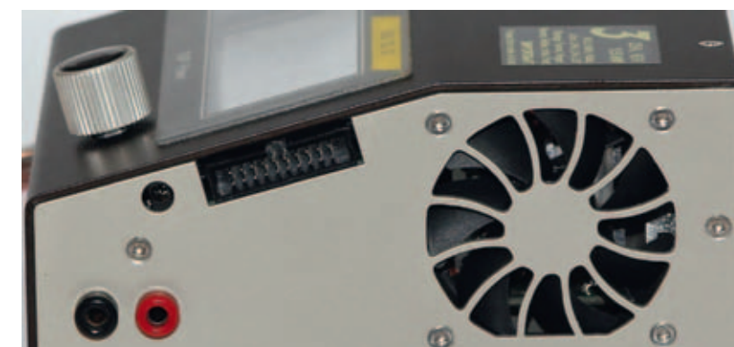
An der rechten Gehäusesseite sind die Ladeanschlüsse, der Balanceranschluss und der Lüfter zu erkennen
