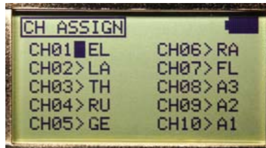
Freie Zuordnung sämtlicher Kanäle. Eine logische Verknüpfung schafft neue Schaltfunktionen
