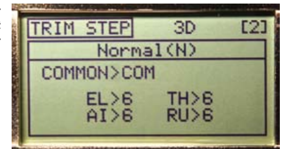
Die Trimmweite der Knüppelkanäle ist getrennt wählbar
