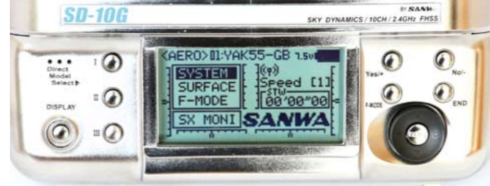
Programmiert wird über mehrere Taster. Das Display informiert ausführlich
