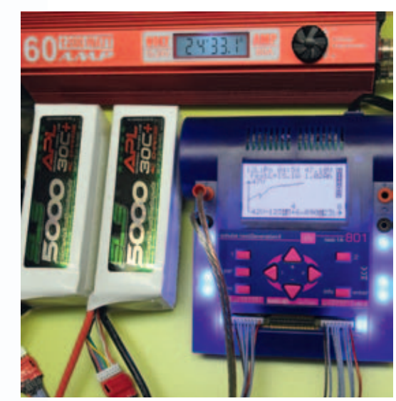
Das nG-14-801 stellt so viel Leistung bereit, dass beide 5s-LiPos in 20 Minuten vollgeladen werden könnten
