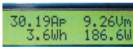
▲ Anlaufspitze und Dauerstrom am AXI2808-Motor
