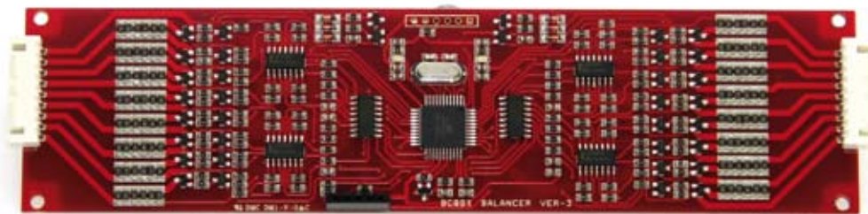
Im Untergrund ist die Balancerplatine zu erahnen. Darauf befindet sich ein zusätzlicher Prozessor zum Ausgleichen der Zellen
