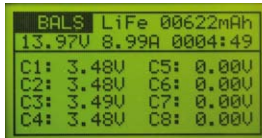
Übersichtliche Einzelzellenspannungs-Anzeige während der Ladung beziehungsweise Entladung. Leider wird eine momentane Aktivität nicht sichtbar
