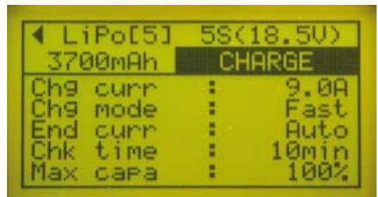
Einstellungen zum LiPo-Lademenü. Hier Speicher 5, 5s-Akkus mit 3.700 Milliamperestunden (3C-Laderate klassifiziert, 9 A Ladestrom, Fast-Ladung, Auto-Abschaltung, Sicherheitscheck nach zehn Minuten, Ladekapazität 100 Prozent)
