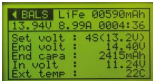
Datenanzeige beim Laden. Als Beispiel musste ein vier Zellen LiFe-Akku (A123) erhalten. Die Überladesicherheit wurde auf 105 Prozent eingestellt (2.415 Milliamperestunden)
