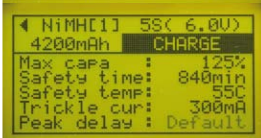
Die erste Seite des Lademenüs und die anschließende Seite ab Max-capa (Überladesicherheit). Leider wird das im Menü nicht erkenntlich
