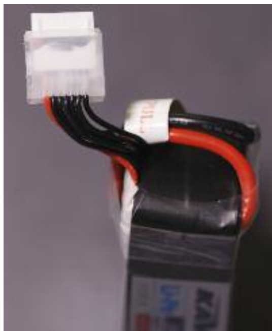
Die Balancerstecker des JST-XH-Systems mit Gehäuse sind sehr grifffreundlich.
