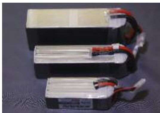
Der zusätzliche Alu-Plattenschutz beim 8.000 mAh-Akku (oben).
