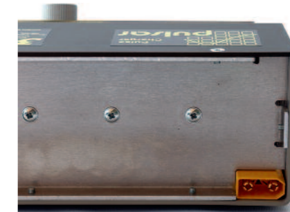
Hinten rechts wurde die XT90-Versorgungsbuchse integriert.
