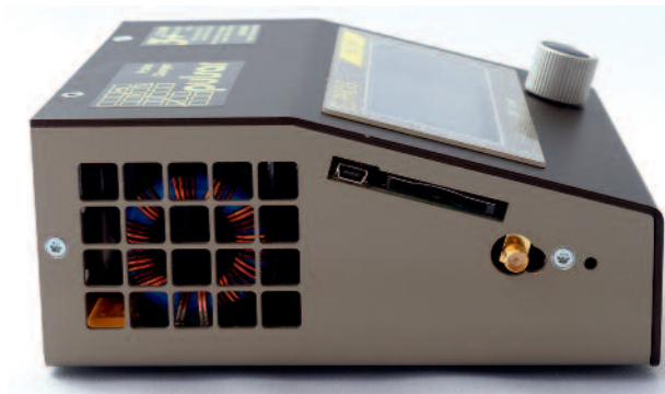
Links am P3+: SD-Kartenschacht, USB-Schnittstelle sowie SMA-Antennenanschluss.
