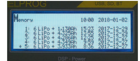
Die letzten acht Ereignisse im Überblick. Im Wechsel zeigt der P3+ die Kapazität (in Ah) oder die Energie (in Wh) an.
