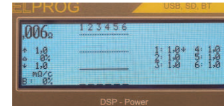
Darstellung des Innenwiderstands eines LiPo-Akkupacks und dessen Einzelzellen beim Laden. Hier ein neuer 6s/5.100 mA/70C mit seitlichen Hochstromableitern.
