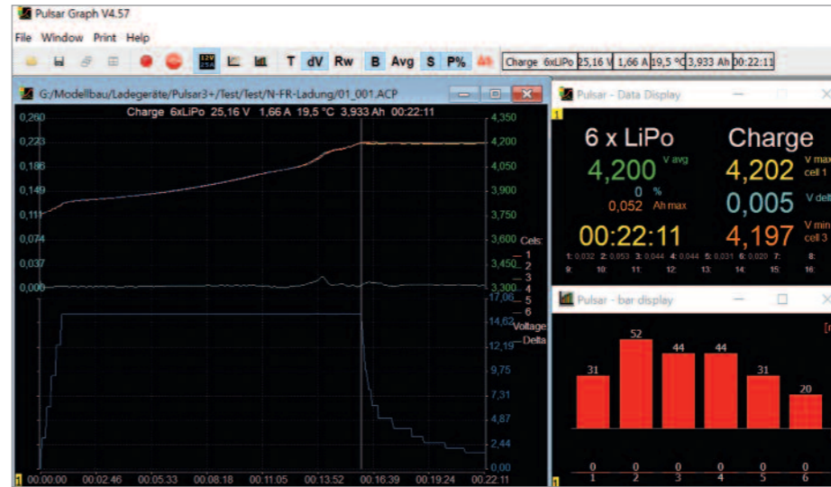
Auszug aus der Pulsar-Graph-Software des P3+: Kurvenverläufe, sämtliche Einzelinformationen per Data-Fenster und ein Beispiel zur benötigten Balancerkapazität zum Angleichen der Einzelzellen.
