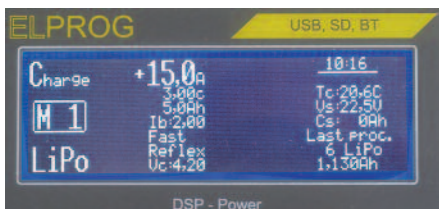
Displaydarstellung zum Laden (Charge). Ein helles Display zeigt bei mir an, wenn der P3+ aus einer Batterie gespeist wird (Inverse-Einstellung).
