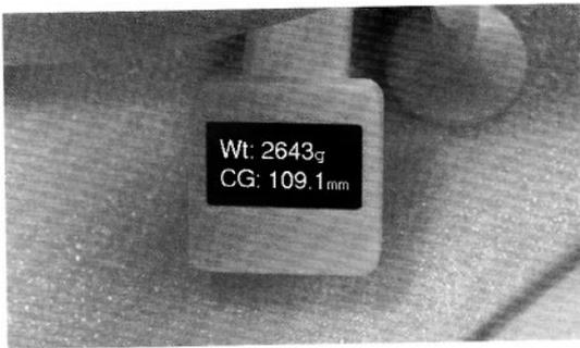
Der Lohn einer vorher gut geplanten Arbeit. Der Schwerpunkt, hier 109 mm und das Gewicht mit 2.643 g passen. Die angestrebten 2.600 g maximal wurden nur leicht überschritten.
