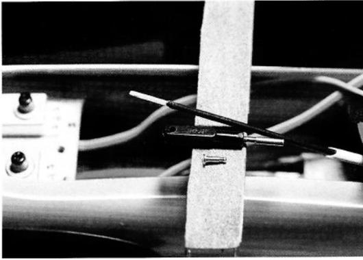
Die Seiten- und Höhenrudieranlenkung ist tricky, weil die äußere schwarze Ummantelung vorsichtig abgeschabt werden muss, um anschließend eine einwandfreie Klebung zu garantieren.
