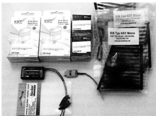
Das technische Equipment: Empfänger, MVario2, Antennendurchführungen, die Servorahmen und die Servos.
