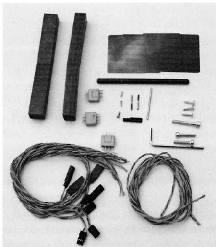
Die Kleinteile u. a mit den CFK-Rechteckverbindern, die Servoabdeckungen, der CFK-Rundholm für die Höhenruder und diverser Kleinteile.
