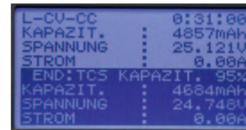
**Der LiPo am Ausgang A1 war nach 31 Minuten vollgeladen. Das Gleiche dauerte an Ausgang A2 bei 95 Prozent TCS nur 17 Minuten**
