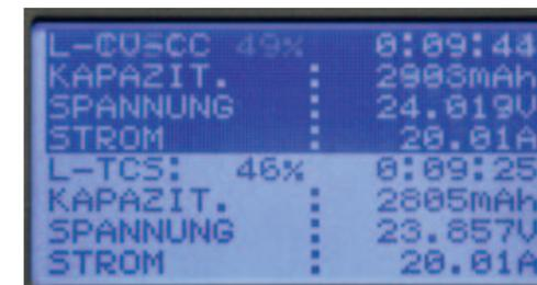
**Ein Beispiel zur Ladepower an 24,4 Volt. Der PPT lädt mit satten zwei mal 20 Ampere die 6s-LiPos**
