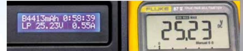
Zur Kontrolle eine Messung zur Gesamtspannung am Ausgang 3 kurz vor dem Abschalten – perfekte Übereinstimmung
