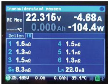
Für eine Innenwiderstandsbestimmung hat der X6 ein gesondertes Programm. Der LiPo wird mit einem Impulsprüfstrom vermessen und die Widerstandswerte dann zur Anzeige gebracht.
