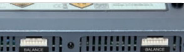
Die Balancerports sind räumlich den Ausgangsbuchsen zugeordnet
