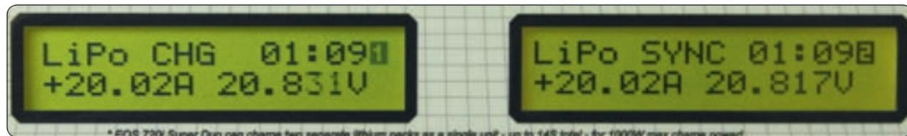
Der Beweis ist erbracht, der mögliche Ladestrom an 24,5 Volt Eingangsspannung beträgt hier satte 20 Ampere. Nicht voll ausgelastet, ergeben das etwa 835 Watt
