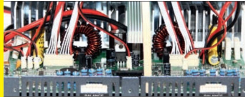
Sauber aufgebautes Inneres. Bis auf die Hochstromleitungen sind sämtliche Leitungen steckbar. Hinter den Balancerports sind die jeweils sieben Balancerwiderstände sichtbar
