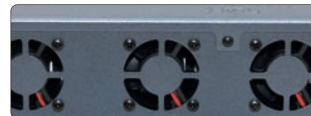
1.000 Watt Lade- oder 80 Watt Entladeleistung erzeugen Wärme, die abgeführt werden muss
