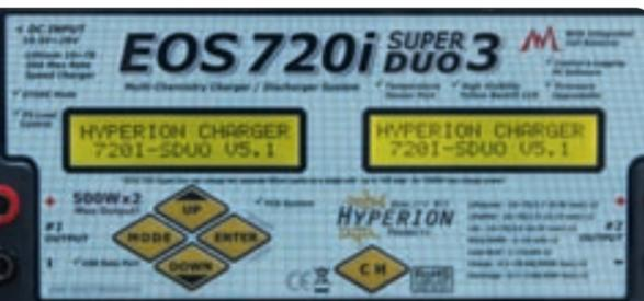
Das gewohnte Bedienpanel von Hyperion. Beide Ausgänge mit eigenem Display. Abgebildet ist die Statusmeldung direkt nach dem Einschalten
